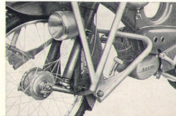
Der Gepäckträger liegt auf vier stabilen Lagerzapfen. Steuerschloß gegen unbefugte Benutzung und Kilometerzähler für genauen Fahrtnachweis.
